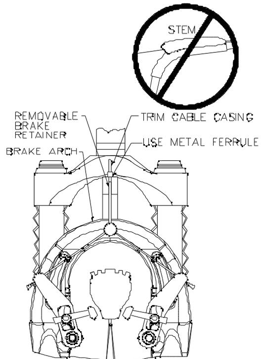
**FIGURE 2: BRAKE CABLE ROUTING**
