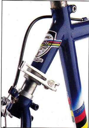
**Minimal-Lösung:** Das Elastomer bietet nur einen Zentimeter Federweg. Mit dem Schnellspanner kann der Mechanismus blockiert werden
