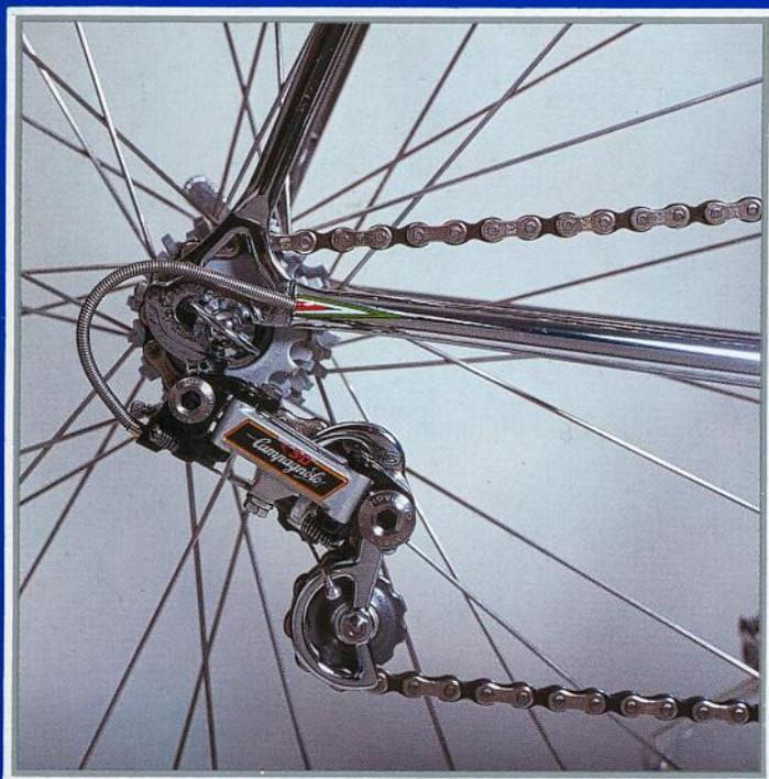
Feinstellung der Wechsel-Diagonale: 3-D System. Durch ICS entwickelt und patentiert. Wird am Kettenwechsel «Campagnolo Super Record» angebracht. Diese ermöglicht, durch die erhöhte Wicklung der Kette auf den Freilaufzahnkranz, eine optimale Kraftübertragung, einen verminderten mechanischen Verschleiss sowie ein beschränktes Überspringen der Kette. Ideal für 6-oder 7-fach Leerläufe mit 11, 12, 13, 14 Zähnen.
