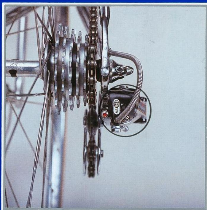
Régulateur de la diagonale du changement de vitesse: Système 3-D. Conçu et réalisé par ICS, breveté. Il est appliqué sur le changement de vitesse «Campagnolo Super Record» et permet, grâce à un plus grand enroulement de la chaîne sur le pignon de la roue libre, une transmission optimale de la force mécanique, moins d'usure et moins de risque de chute de la chaîne. Idéal pour les roues libres à 6 ou 7 couronnes à 11, 12, 13, 14 empreintes.
