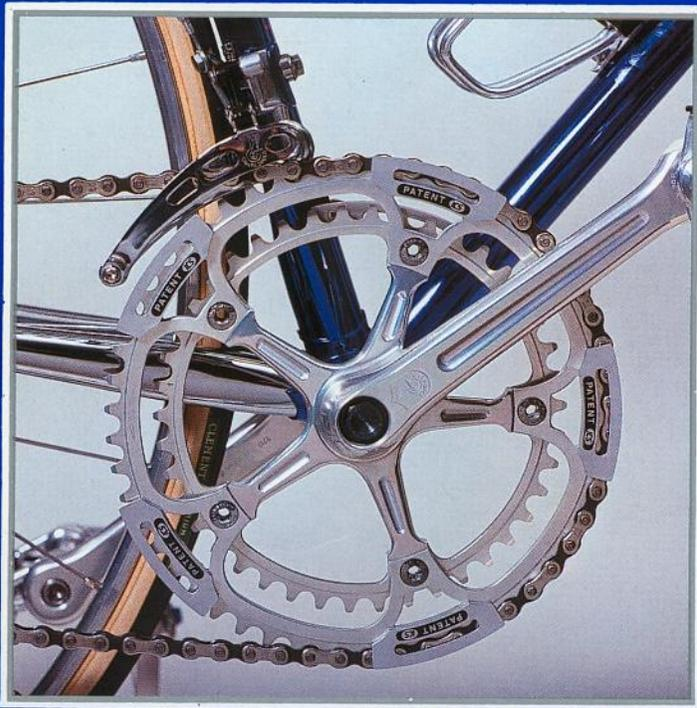
Kettenführungs-Zusatz (KFS), von der ICS entwickelt und patentiert. Er vermeidet das Herausfallen der Kette an beiden Kettenrädern während der Gangschaltung, bedingt durch allzu grosses Schrägläufen der Kette, oder durch mechanischen Verschleiss sowie beim Auswechseln des Hinterrades.
