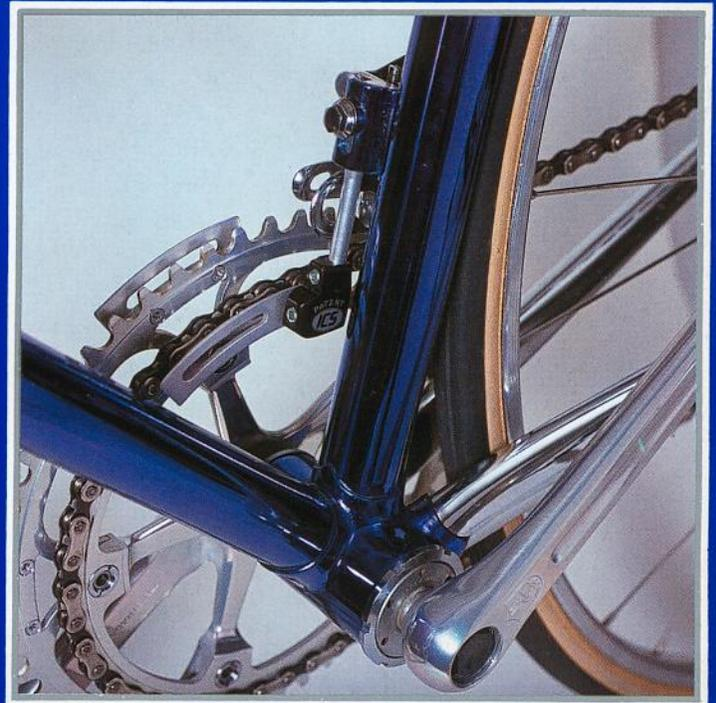
Groupe guide-chaîne (KFS), conçu et réalisé par ICS, breveté, empêche la chute de la chaîne des pignons sur les deux côtés pendant la phase de changement de vitesse, due à une excessive inclinaison de la chaîne par rapport aux pignons de la roue libre et à usure mécanique, ou pendant le remplacement de la roue arrière.
