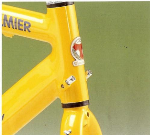
Telaio estremamente leggero, realizzato con tubazione in alluminio Columbus Altec 2. Forcella Unicrown costruita in acciaio Columbus Genius con la massima cura e un'inclinazione ottimale per garantire alte prestazioni e una guida confortevole. Batticatena del telaio lucidato. La scelta della forcella in acciaio proposta sui telai in alluminio non è casuale. Deriva dalla necessità di neutralizzare l'eccessiva rigidità del telaio senza comprometterne la leggerezza.
