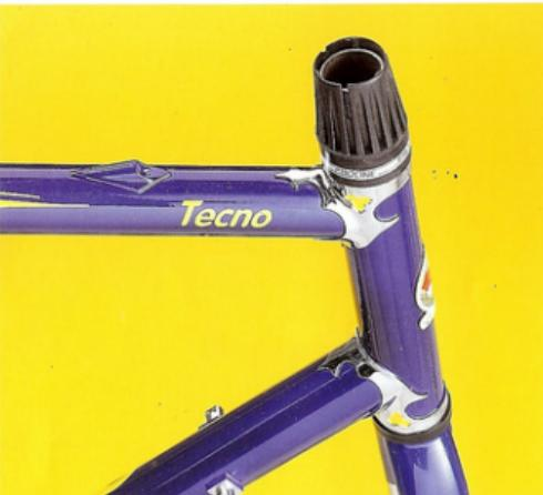
Tubazione completa Columbus E.L. O.S. in acciaio Nivacrom.
