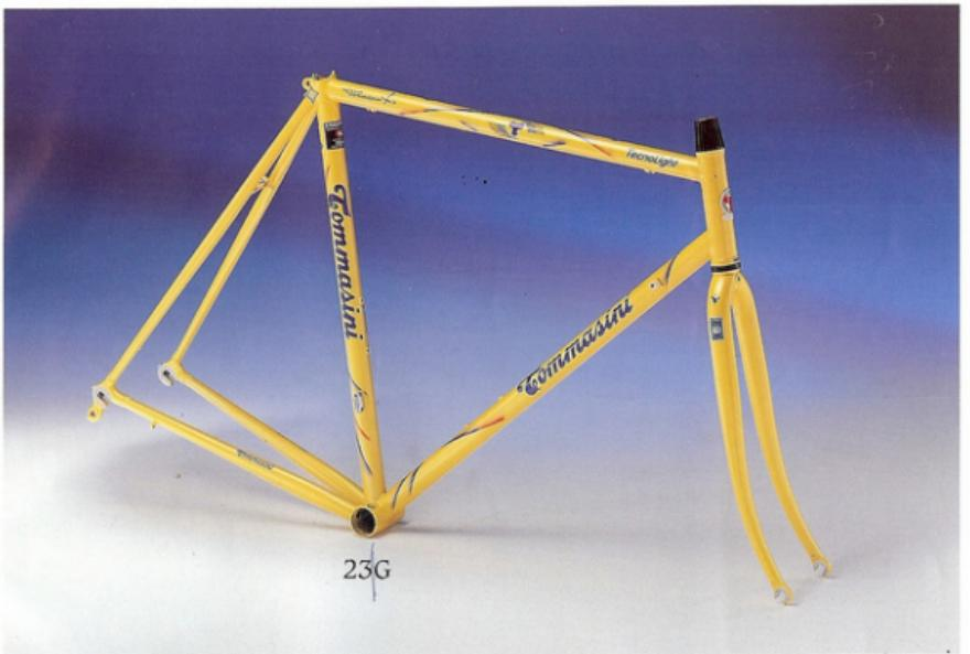
Telaio costruito con tubazione Columbus Nemo, acciaio Nivacrom, la più leggera in assoluto. Saldatura a TIG, personalizzato dall'originale congiunzione reggisella e dai nuovissimi ed esclusivi forcellini microfusi. Forcellini, punte forcella e attacco deragliatore cromati. Tutti i telai saldati con tecnica Tg hanno gli attacchi fermaguaina con registro al tubo sterzo.
