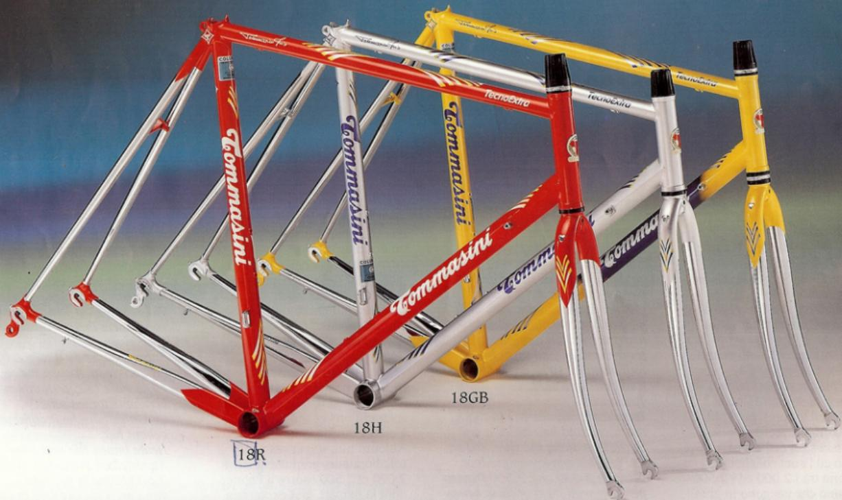
Telaio costruito con tubazione Genius, acciaio Nivacrom, a sezioni differenziate, ideata da Tommasini e per lui realizzata dalla Columbus, telaio saldato a TIG, di altissima qualità, molto rigido, forte e leggero, adatto a competizioni estreme, tubo con posteriore, forcella e attacco deragliatore cromati. Tutti i telai saldati con tecnica Tig hanno gli attacchi fermagugina con registro al tubo sterzo.
