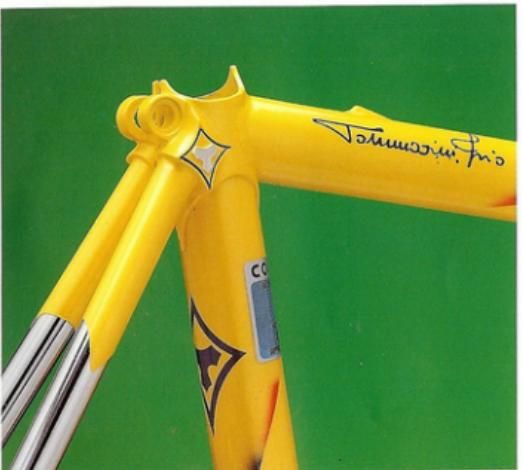
Telaio costruito con tubazione Columbus Genius, acciaio Nivacrom. Saldato a TIG. Leggero, adatto per competizioni di alto livello. Posteriore, forcella e attacco deragliatore cromati. Tutti i telai saldati con tecnica Tig hanno gli attacchi fermaguaina con registro al tubo sterzo.
