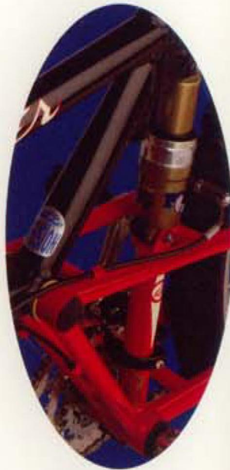
ermöglichen zusätzlich eine bessere Befestigung des Schaltwerks, was ein sauberes Schalten erleichtert. Sie haben abgeschrägte Außenseiten, die die Nabe sauber in den Rahmen leiten. Alle Breezer Rahmen, ob aus Stahl oder Aluminium, sind mit Breeze-In Ausfallenden ausgerüstet.
