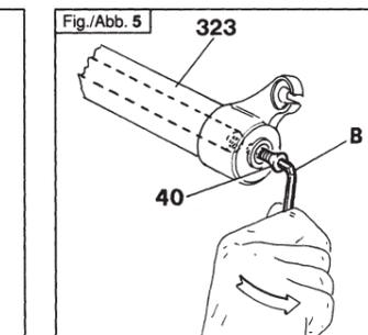
PRECARICA DEGLI ELASTOMERI - ELASTOMER PRELOAD - PRÉCHARGE DES ÉLASTOMÈRES - VORBELASTUNG DER ELASTOMER-GUMMIS
