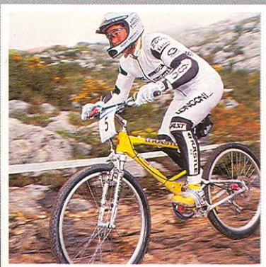
specificatamente per la discesa, la forcella DH3 ha la testa forgiata e rinforzata, gli steli forgiati in T6, l'archetto freno estremamente rigido. Grazie alla sua lunga corsa ed allo smorzamento controllato, assorbe ogni tipo di shock senza penalizzare la stabilità. I tubi sovradiimensionati la rendono una delle forcelle più rigide in circolazione. Essendo stata progettata per i freni a disco, sono disponibili diversi adattatori.
