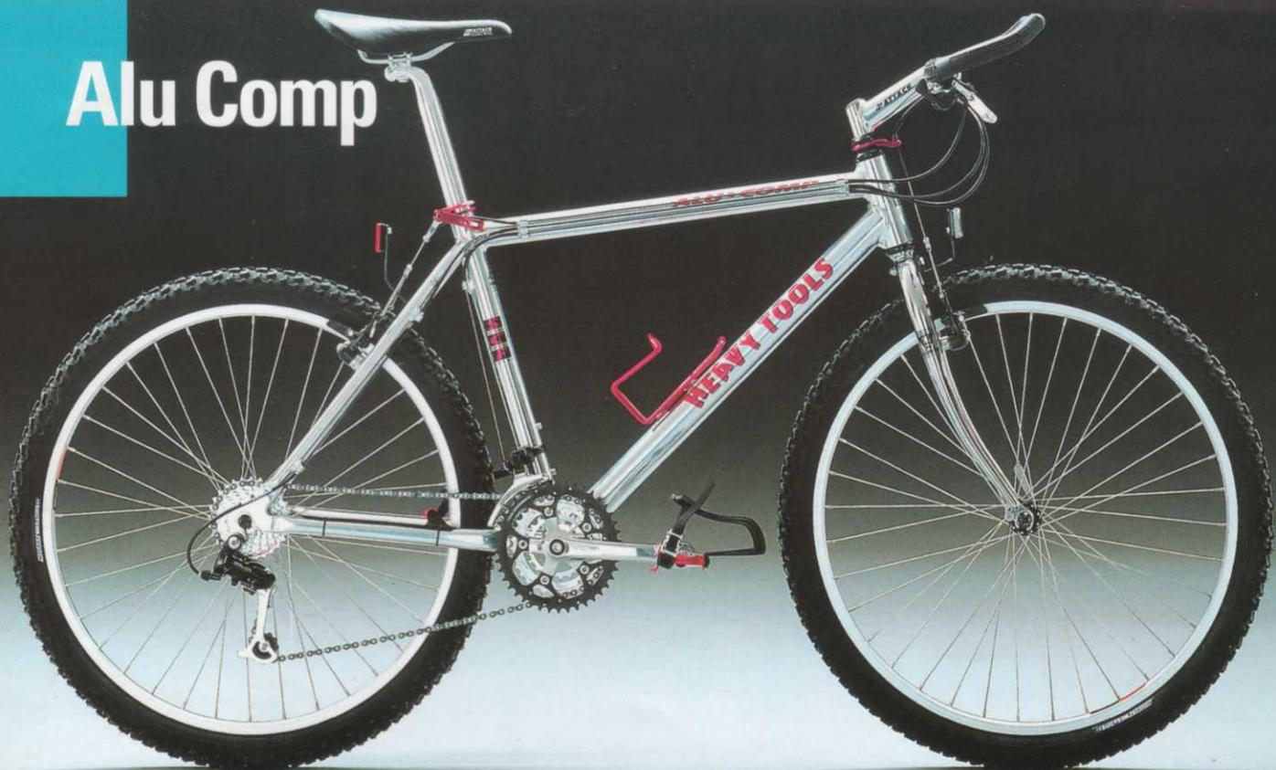
**Sportliches Mountainbike mit Alu-Rahmen** • RAHMEN: AL 7005-T6, LITE SERIES, double butted, heat treated • GABEL: FLEX RESPONSE, full CrMo tripple butted,  $\varnothing 28,6$  mm • ANTRIEBSGRUPPE: SHIMANO Deore LX, 7-fach • REIFEN: RITCHEY Megabite C-900 26 x 1,9" • FELGEN: ARAYA, TM-18AL, 26", 32 Loch, silver • SONSTIGES: Hornbar Lenker, Pedalhaken, CrMo-Sattel • GEWICHT: ca. 11 kg • FARBE: Alu poliert GRÖSSEN: 440/470/500 • Auch mit Federgabel erhältlich.
