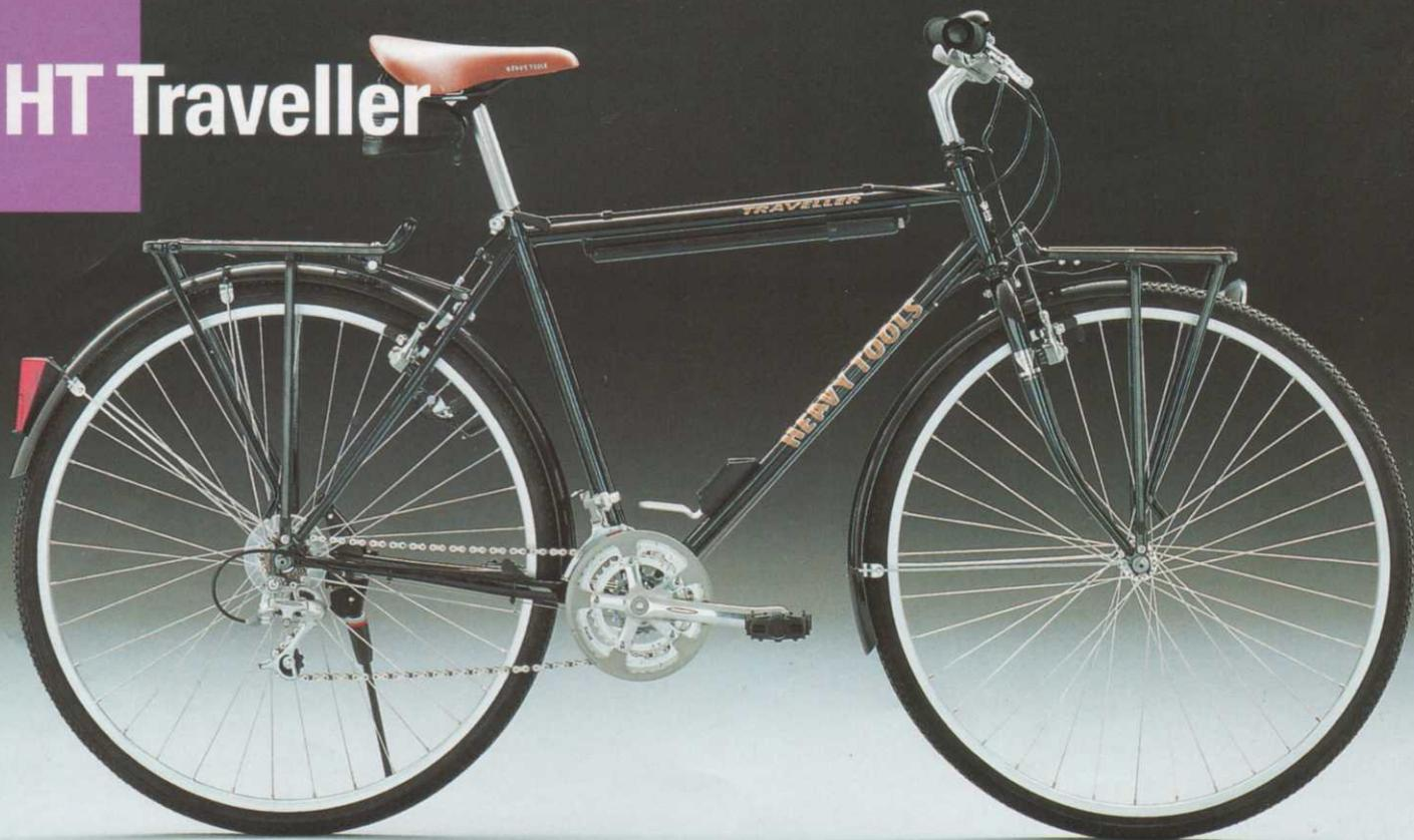
**Trekking-Bike mit Komplettausstattung und hochwertigen Komponenten.** • RAHMEN: TRI-MOLY, double butted • GABEL: FLEX RESPONSE, full CrMo,  $\varnothing 25,4$  mm
