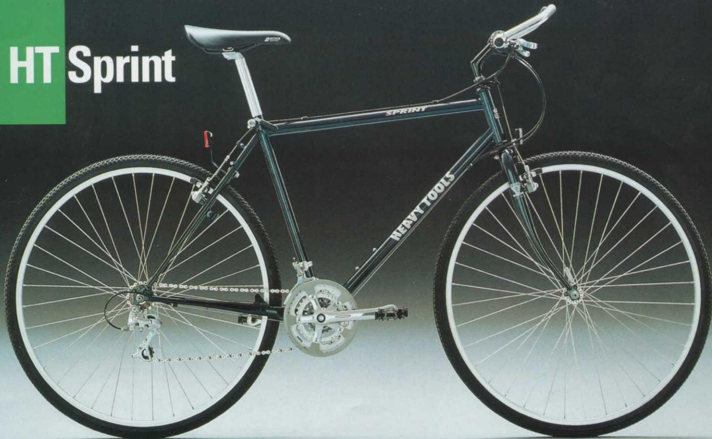
**Sportliches Trekking-Bike mit leichtem CrMo-Rahmen und hochwertigen Komponenten** • RAHMEN: TRI-MOLY, butted • GABEL: FLEX RESPONSE, CrMo,  $\varnothing 25,4$  mm • ANTRIEBSGRUPPE: SHIMANO 400 CX, Schalter GRIP SHIFT • BREMGRIFFE: DIA COMPE SS4 • REIFEN: CHENG SHIN, C 1053, 700 x 40C • FELGEN: ARAYA, VX-300, 700, 36 Loch, silber • GEWICHT: ca. 12,3 kg • SONSTIGES: Trinkflasche, Lenkerhörner • FARBE: Nachtblau • GRÖSSEN: 500/530/560
