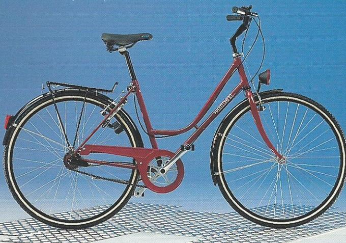
Cadre "Swiss Made" en tubes d'acier soudés à la main. Changement de vitesse dans le moyeu.
