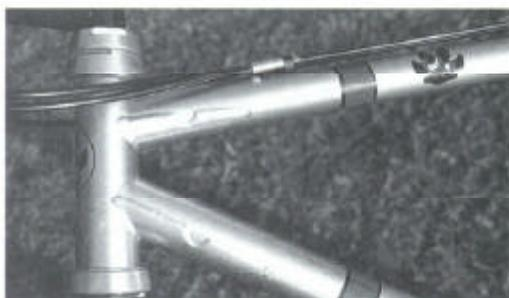
Die Gussets-Verstärkungsbleche sollen die kritischen Zonen entlasten. Das hoch angesetzte Unterrohr mindert die thermische Belastung der Steuerlagerregion.
