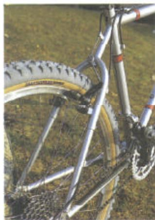
Der Wishbone-Hinterbau wirkt fast zierlich, ist aber ausreichend stabil. Im unteren Teil sind die Sitzstreben 5/8 Zoll stark, im oberen Teil 3/4 Zoll - geringes Gewicht wo möglich, mehr Steifigkeit wo nötig. Die Cantileversockel sind auswechselbar.
