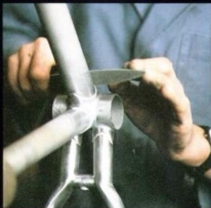
Après décapage, un léger sablage permet d'entreprendre la finition de tous les raccords.
