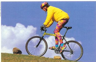
Der Sling-Shot-Rahmen verhindert das Durchdrehen des Hinterrades im Wiegetritt.
