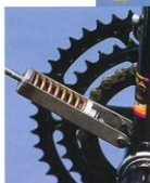
Ein Federlelement im Bereich des Tretlagers unterstützt den „runden“, kraftsparenden Tritt.
