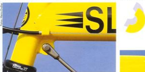
Anstelle eines herkömmlichen Unterrohres tritt beim Rahmen des Green-Dele Sling Shot ein drei Millimeter starkes Kabel aus Stahldrähten.
