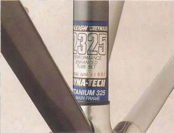
wickelten, dünnwandigeren REYNOLDS-Hauptrohre mit hochwertigsten Aluminium-Muffen. Jedes unserer DYNA-TECH-Rennräder erhält nach der Endkontrolle den speziellen Sticker mit eingepprägter Seriennummer des Rahmens. Unverwechselbares Kennzeichen für Individualität. Weitere, detaillierte Informationen, z. B. auch über Rahmengenometrien unserer Rennräder schicken wir Ihnen gerne:
