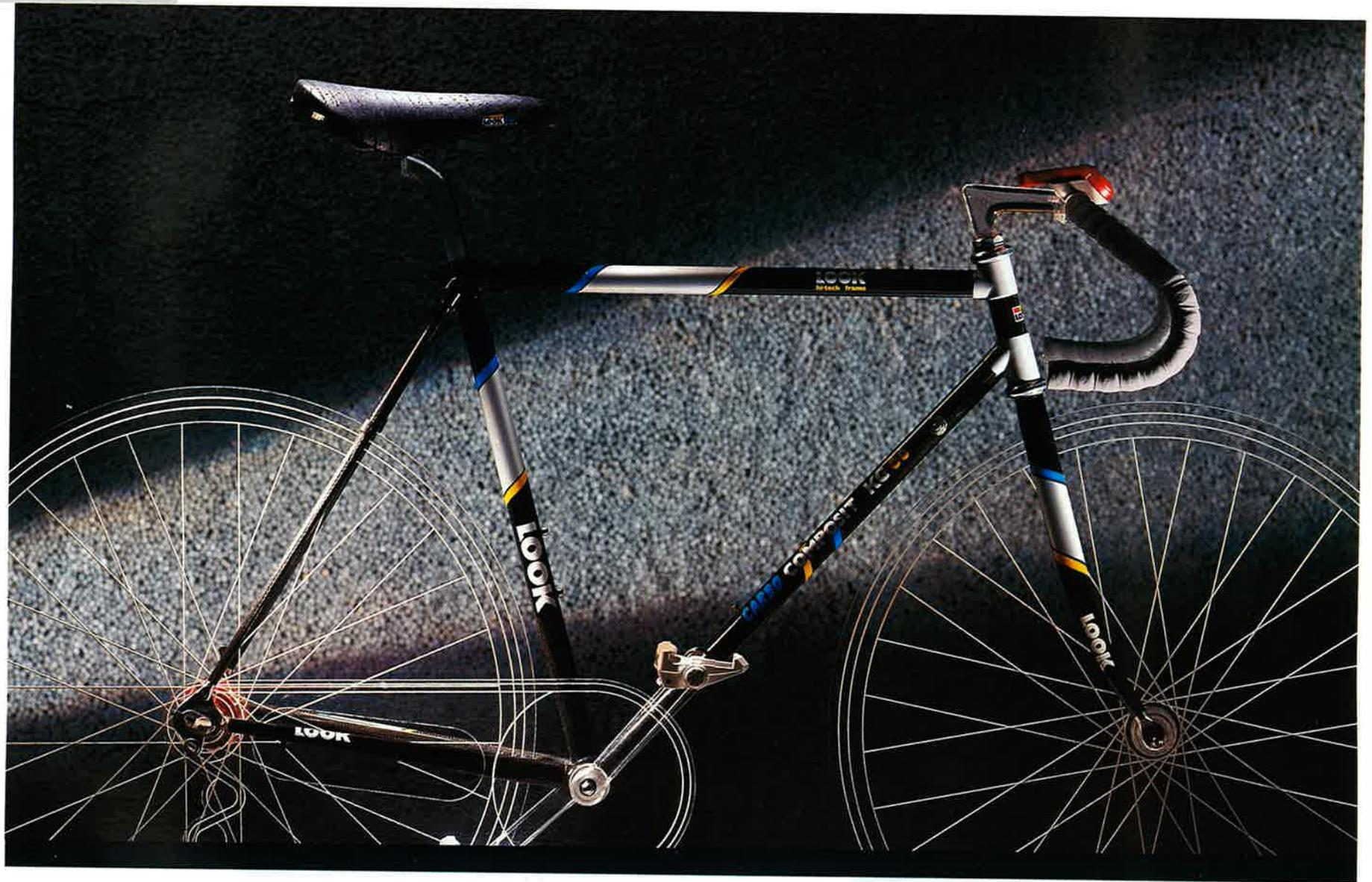
Avec sa structure **80% Carbone et 20% Fibre de Verre**, le KG 66 Carbo Composit est un phénomène! Car utiliser le verre (silice + carbonate de sodium et
