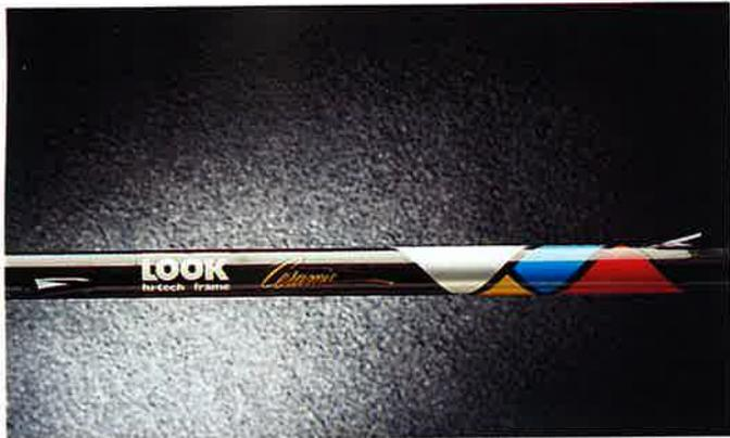
En effet, l'utilisation de fibres de **Céramique** est venue renforcer la structure spécifique tresses et poutres du Carbone et du Kevlar.
