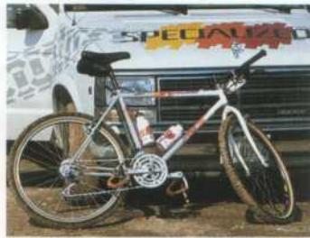
• **Die Geometrie des geneigten Oberrohres:** Specialized verwendet im SFS-Rahmensystem ein grossbemessenes, geneigtes Oberrohr, durch welches 1.) die Verwindungssteifigkeit erhöht, 2.) die Fahrt gedämpft und 3.) Gewicht gespart wird. Die Stellung des Oberrohres im Verhältnis zum Unterrohr verbessert die vertikale Nachgiebigkeit und steigert den Fahrkomfort.
