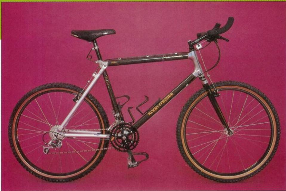
**W**elche Maßnahmen erforderlich sind, um Rahmen aus leichten Werkstoffen mit größerer Elastizität – wie Aluminium oder Kohlefaser – zu guter Steifigkeit zu verhelfen, hat sich mittlerweile herumgesprochen. Man hebt den Durchmesser der Rahmenrohre bei gleicher oder sogar etwas verringerter Wandstärke an, schon hat man den theoretischen Nachteil der „weicheren“ Materialien wieder ausgeglichen.
