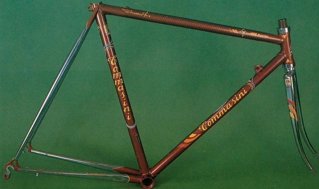
I telai sono costruiti su misura con sistema di lavorazione artigianale utilizzando tubazioni "COLUMBUS". La testa forcella, la scatola movimento e le congiunzioni sono in microfusione modello TOMMASINI. Per l'assemblaggio dei vari componenti, le biciclette sono equipaggiate con i migliori prodotti nazionali ed esteri.
