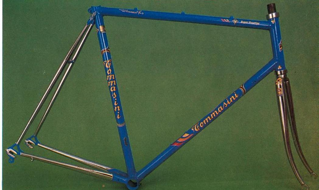
**MODELLO SUPER PRESTIGE:** tubazione Columbus SL con posteriore e forcella aerodinamici. Congiunzioni e scatola movimento in microfusione personalizzati, testa forcella aerodinamica in microfusione nostro modello brevettato, ponticello e pendine pantografati Tommasini. Lavorazione accuratissima. Tutte le misure dal 49 al 65/66 anche su dati forniti dal cliente. Colori vari. Forcella e posteriore telaio interamente cromati.
