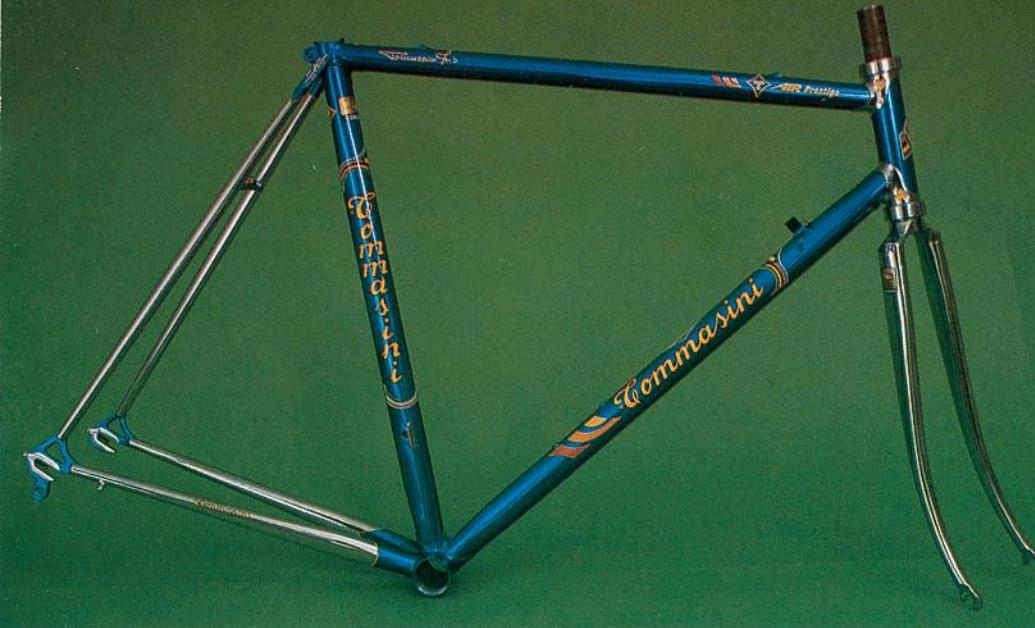
**MODELLO AIR PRESTIGE:** tubazione Columbus SL, tutti gli attacchi saldati compreso quello per il deragliatore, congiunzioni e scatola movimento in microfusione personalizzati, testa forcella aerodinamica in microfusione nostro modello brevettato, ponticello e pendine pantografati Tommasini. Fili comandi e freno posteriore interni. Lavorazione accuratissima. Tutte le misure dal 49 al 65/66 anche su dati forniti dal cliente. Forcella e posteriore telaio interamente cromati.
