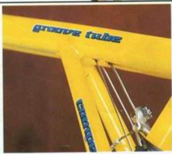
GROOVE TUBE™: Das von GT und TRUE TEMPER® entwickelte Oberrohr ermöglicht eine saubere, funktionell verbesserte Zugführung
